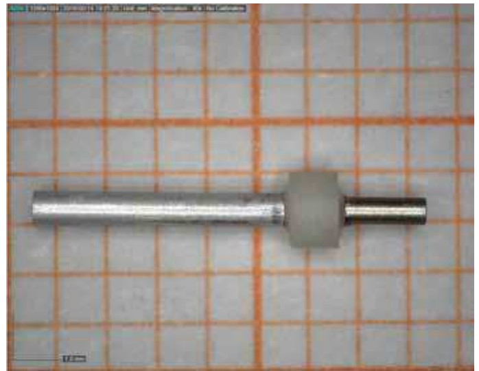
Mikrospritzgussteil – 2 Metallkomponenten – zusammengefügt und umspritzt im HIMICO -Projekt. Foto: Wittner
