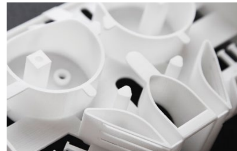
3D-gedruckte Spleisskassette zur Verbindung von Glasfaserleitungen.
