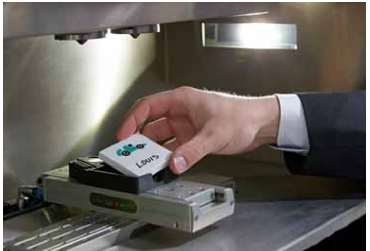
Durch die Möglichkeit, auf bestehenden Teilen aufzubauen, ist der Freeformer prädestiniert für die Individualisierung von Industrieprodukten. Hier ein Lichtschalter mit Namenszug.
