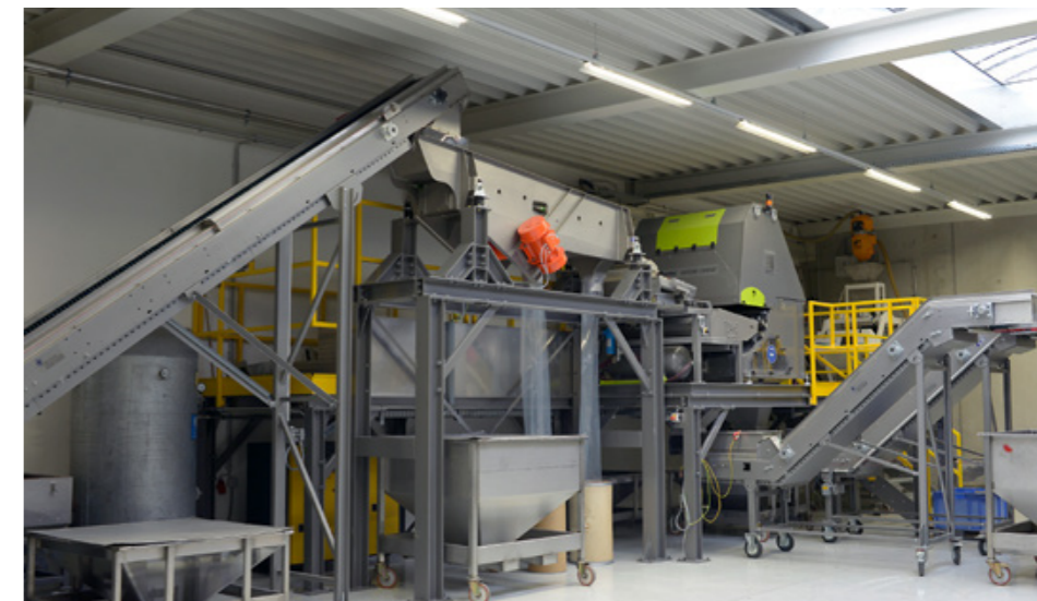
Wind hat 1,7 Mio Euro in eine komplette Upcycling-Anlage investiert, mit der Kunststoffabfälle vermahlen, sortiert und regranuliert werden können. Bild: Chemiereport/Nadine Bargad
