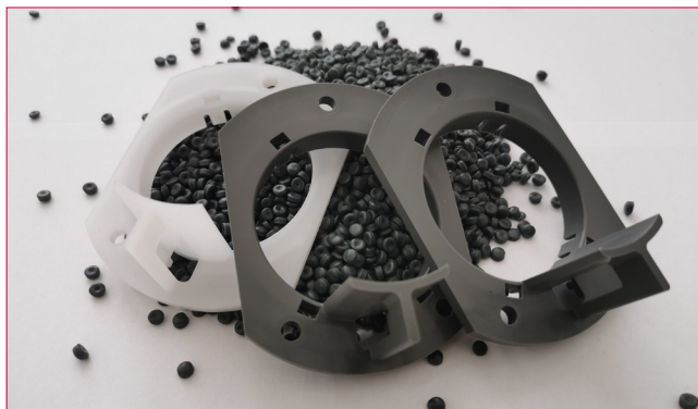
Abbildung 5: Beispiele der ÖkoEff-Schelle aus Neuware (links) und Rezyklat
