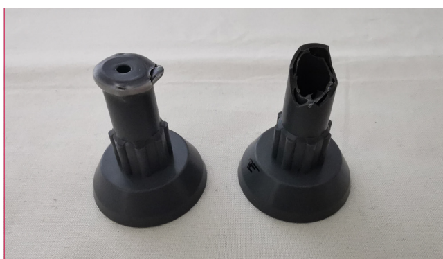
Abbildung 8: Nagelkonus nach dem Impactversuch bei -20^{\circ}\text{C} (links: PE-Rezyklat, rechts: PE-Rezyklat mit höherem PP-Anteil)
