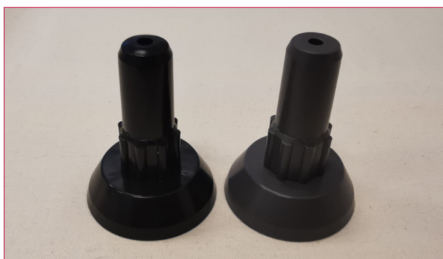
Abbildung 7: Nagelkonus aus Originalmaterial (HDPE, links) und PE-Rezyklat (rechts)
