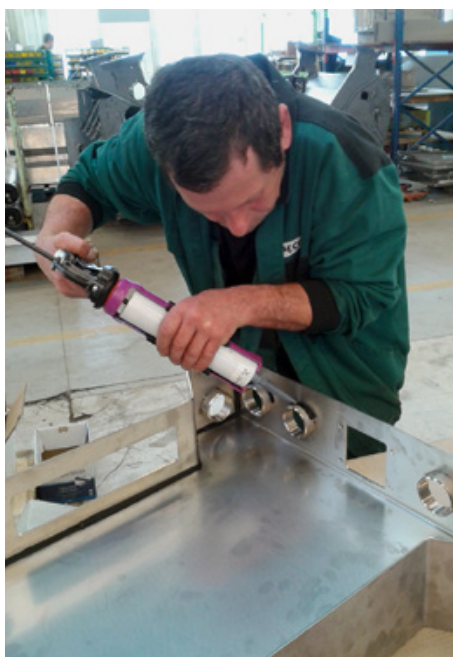
Durch ein Kleben statt Schweißen sollten die Kosten in der Fertigung verringert, aber auch die Qualität der Bauteile durch weniger Verzug verbessert werden. Bild: Sustainable Innovation e.U., Dr. Werner Ahrer
