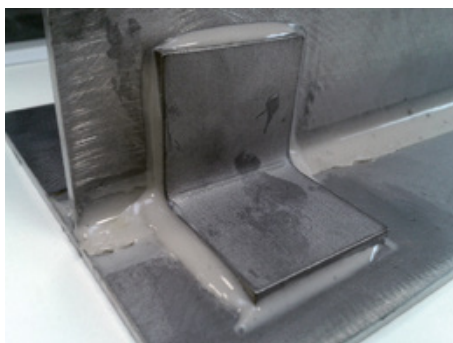
Verklebung der Blechteile mit Hilfe von Winkeln. Bild: Sustainable Innovation e.U., Dr. Werner Ahrer
