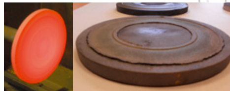
Einschmelzen (links) der Karbidsschicht bei rotierender Scheibe und die resultierende Beschichtung (rechts) Bild Hintergrund: Konstruktionszeichnung Lochscheibe
