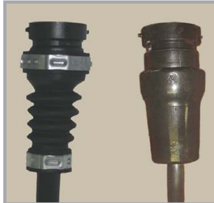
Stecker mit Tülle und Schellen werden durch Steckverbinder, die wasserdicht umspritzt werden, ersetzt.
