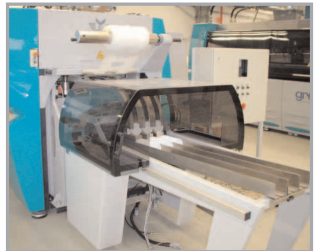
Thermoformanlage mit neu entwickeltem Stapelgerät
