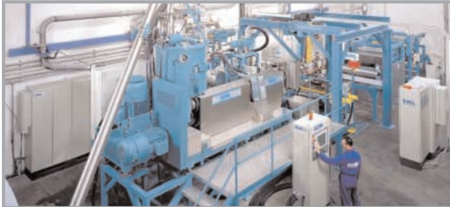
Extrusionssystem für die Inline-Flachfolienherstellung aus PET bottle flakes
