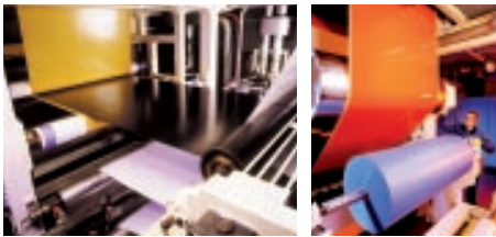
Prepreg-Herstellung bei Hexcel.
