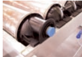
Spritzgegossene Kapfen aus Grivory® HT... FWA in 3 Anschlussvarianten erleichtern u.a. die Servicierbarkeit der Gesamtanlage.
