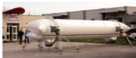
Sonnenkonzentratoren: Der HELIOtube wiegt nur 5 Kilogramm pro Quadratmeter Spiegelfläche, im Vergleich zu den 130 Kilogramm der derzeit gängigen Parabolrinnen-Systeme.
