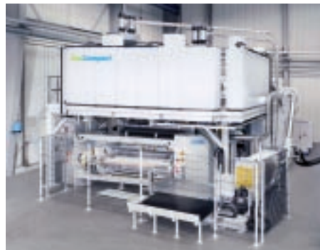
EcoCompact: Die letzte Entwicklung von SML – eine kompakte Stretchanlage. Sie benötigt nur halb so viel Platz wie eine herkömmliche Stretchfolienanlage.
