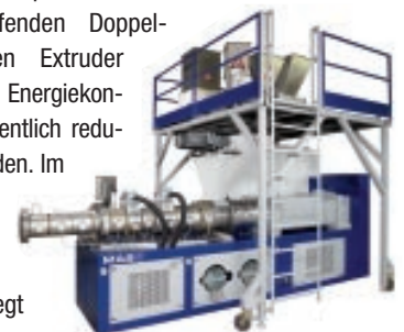
Extruder MAS 90 für WPC-Compoundierung mit Flüssigkeitskühlung
