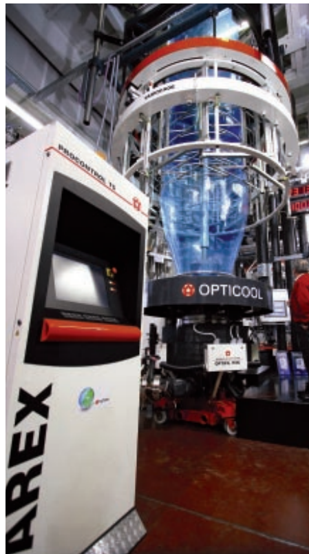
Bild 6: Weltrekord in der Ausstoßleistung mit der 5-Schicht-Blasfolienanlage VAREX für Polyolefine (Quelle: Foto mit freundlicher Genehmigung von WINDMÜLLER & HÖLSCHER).
