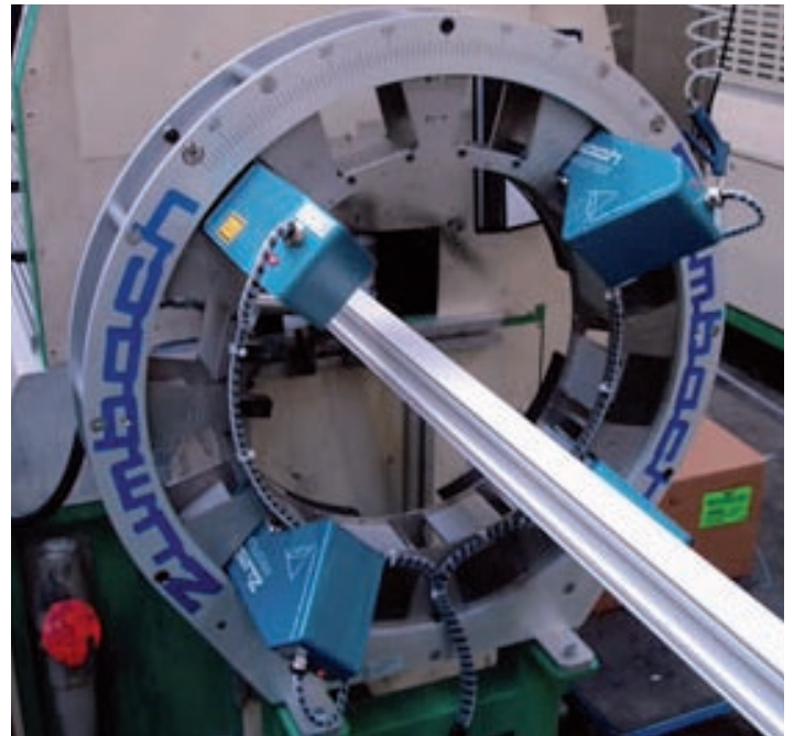
Bild 2: PROFILEMASTER® PMM 140-4K-JV2 zur kontinuierlichen Vermessung von Tür- und Fensterprofilen (Quelle: Zumbach).
