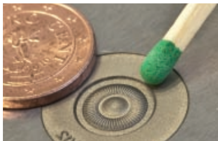
Laser-Abtragverfahren: Die Technologie für filigranste Kavitäten.
