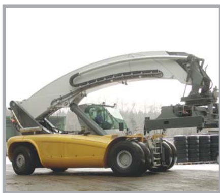
Fünf selbst tragenden Bauelemente aus Glasfaser verstärkten Kunststoffen (GFK) für diesen neuartigen Teelader wurden in dem Projekt entwickelt.
