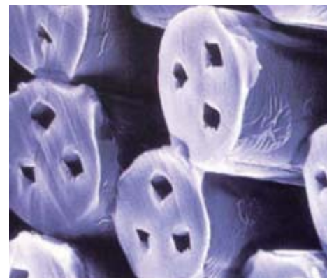
Die AFC (Anti fire crack) Faser mit drei Hohlräumen wurde eigens für Betonbeimischungen entwickelt.
