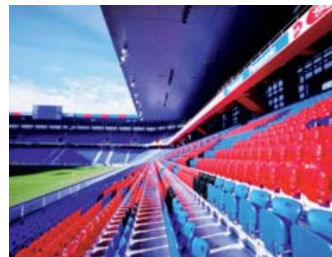
Bei einer Stadionbestuhlung ist eine geeignete Kombination von Flammschutz- und Lichtschutzmitteln erforderlich.
