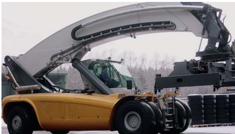
Fünf selbst tragende Bauelemente aus glasfaserverstärkten Kunststoffen (GFK) für diesen neuartigen Teelader wurden innerhalb des Projekts entwickelt.
