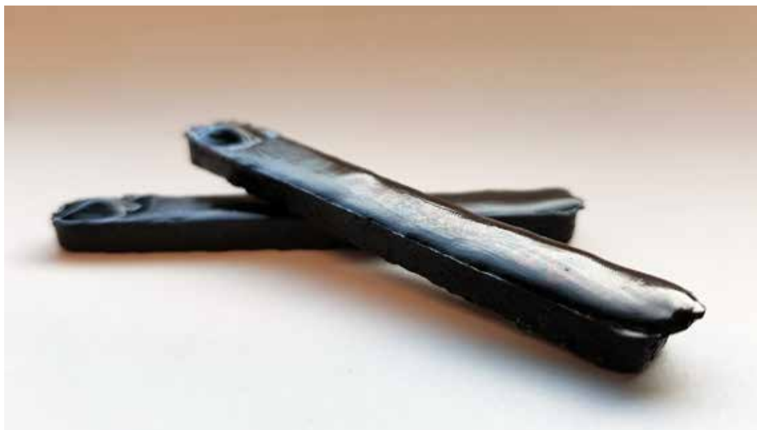
Ein mit Licht ausgehärtetes Harz-Stäbchen .
