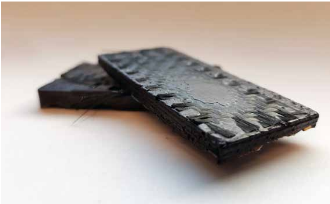
Kohlenfaserplatten, mit dem neuen Epoxidharz .
