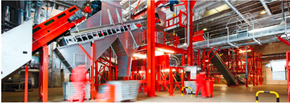
In einem mehrstufigen Prozess werden die handtellergroßen Stücke (Reifenshreds) in einer Granulierungspresse stufenweise zerkleinert. Bild: KIAS
