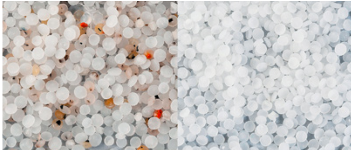
Kunststoffgranulat vor und nach der Analyse und Sortierung in der neuen Inspektionsanlage der Firma Minger Kunststofftechnik AG in Appenzell. Bild: Minger
