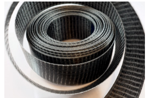
Composite-Tapes werden zur Reduktion des Verschnitts eingesetzt. Bild: TCKT
