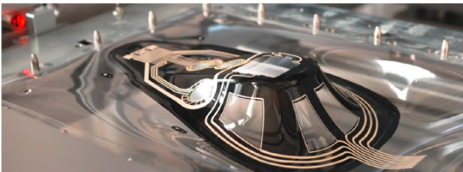
Eine im Forschungsprojekt 3D-MEOD entwickelte interaktive Bedienoberfläche ist in ersten Funktionsmustern vorhanden und macht Schalter überflüssig. Bild: Niebling GmbH
