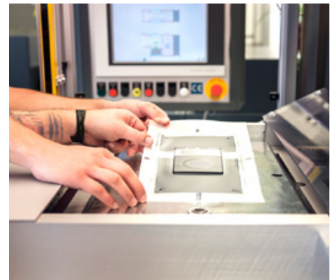
Hochdruckverformung von FIM-Folien. Bild: Siedru
