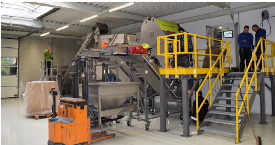
Optische Sortierung bei Wind mit einer Sortieranlage der Firma Sesotec. Bild: Wind
