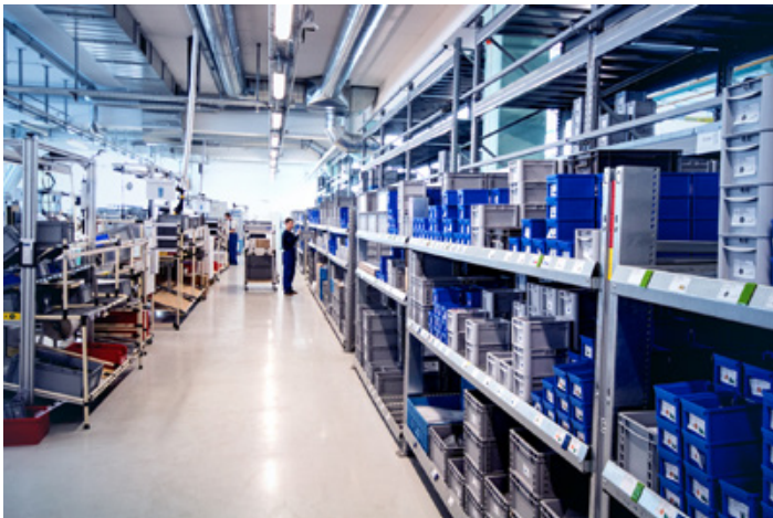
Der Supermarkt ist Schnittstelle zwischen den Spritzgussmaschinen und der Spendermontage. Bild: HAGLEITNER
