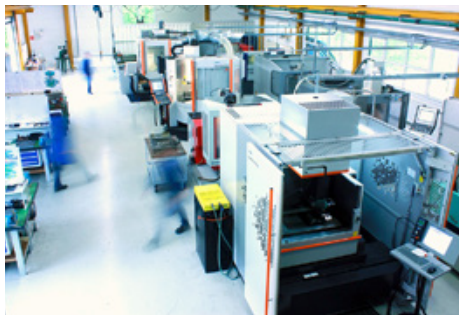
Werkzeugbau bei der Putz GmbH: Erodieren, HSC Fräsen, Graphitbearbeitung und Tieflochbohren. Bild: Putz
