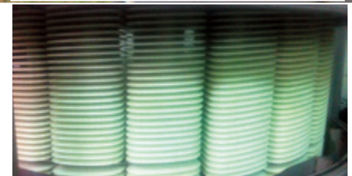
ZELIX ist mit rotierenden Filtermodulen ein hochdynamisches Membranverfahren. Bilder: Pantreon GmbH
