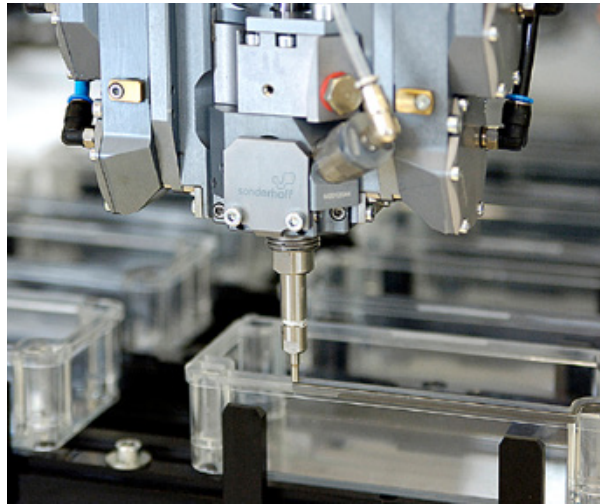
Material, Maschine und Service von Sonderhoff: Konturgenaues Dichtungsschäumen mit dem Mischkopf MK 600. Bild: Sonderhoff
