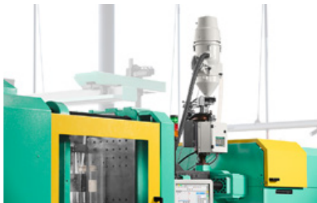
Mit dem Profoam-Verfahren lassen sich faserverstärkte Kunststoffe physikalisch schäumen und z. B. zu einem Airbag-Gehäuse verarbeiten.
