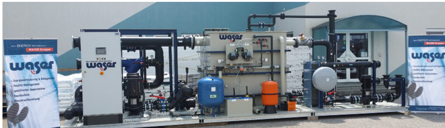
Hochvolumenstrom-Anwendung zur Tiefziehenanwendung, 1,8 K (= Temperaturunterschied zwischen Vor- und Rücklauf des Kühlwassers), 500 kW, für ein osteuropäisches Werk, „Plug'n function ready“ inkl. Steuerung, Wasseraufbereitung und Vorabinbetriebnahme im Waser-Stammhaus. Bild: Waser
