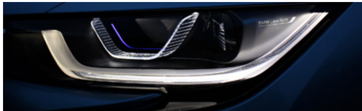
Mehr Sicherheit bei Nachtfahrten – Laserlicht im BMW i8. Bild: BMW Group
