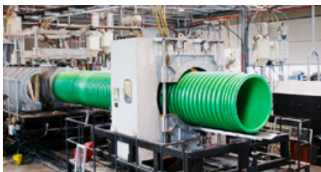
PP-MEGA-Produktionsanlage (1200er Rohr in SN16). Bild: Bauernfeind
