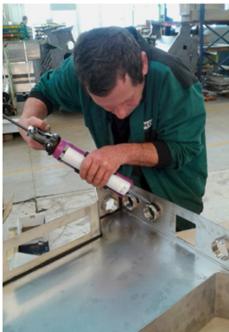
Durch ein Kleben statt Schweißen sollten die Kosten in der Fertigung verringert, aber auch die Qualität der Bauteile durch weniger Verzug verbessert werden.
