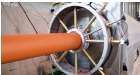
Neue Produktionsanlage für einschichtige Vollwandrohre (PP-GLATT-Rohre). Bild: Bauernfeind
