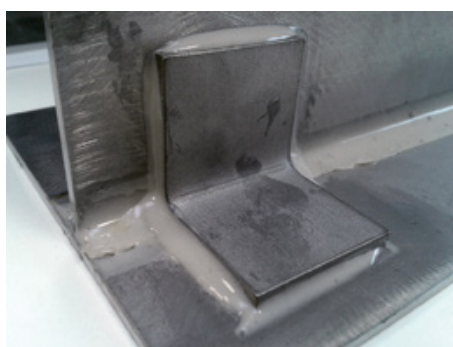
Verklebung der Blechteile mit Hilfe von Winkeln.
