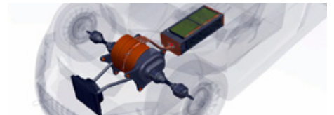
Soll im Projekt „LIVE“ entwickelt werden: Elektrischer Leichtbau-Antriebsstrang mit Torque Vectoring und Hochleistungs-Akku. Bild: j-sigma-b
