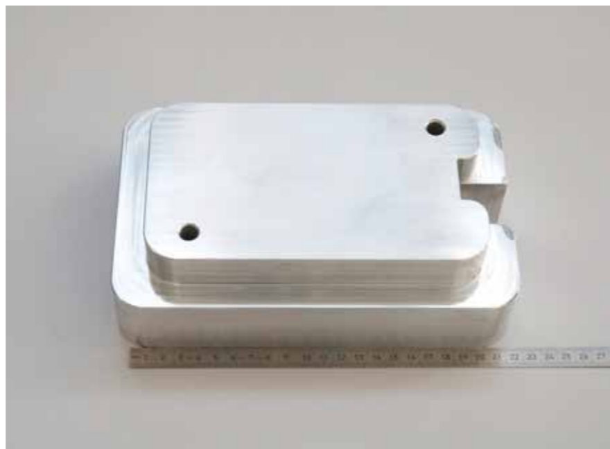
Der WAAM-Einsatz für Fronius wurde anhand aller im Projekt gewonnen Erkenntnisse gefertigt. Bild: TU Ilmenau
