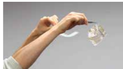
Die auf Folie gedruckte Elektronik ist extrem dünn und zwanzigmal leichter als Papier. Bild: JKU
