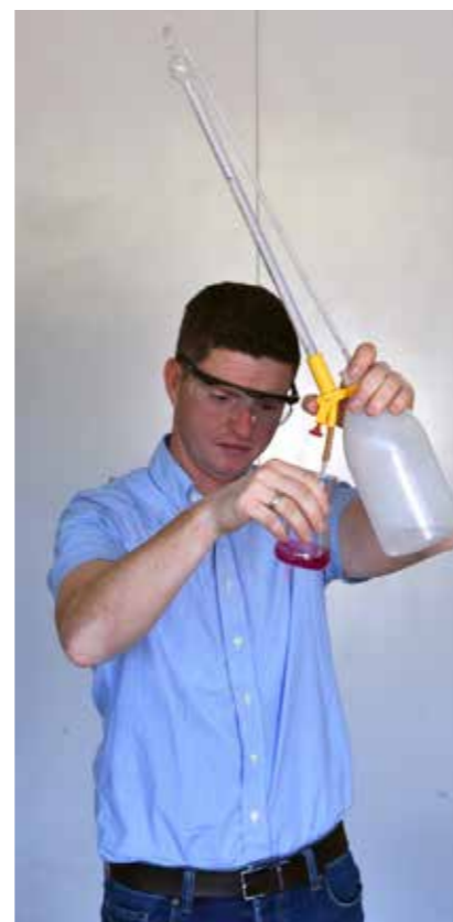
Einmal pro Monat besucht ein Mitarbeiter von MAP PAMMINGER die Firma Haidlmair, um die Reinigerkonzentration zu überprüfen. Bild: Peter Kempfner
