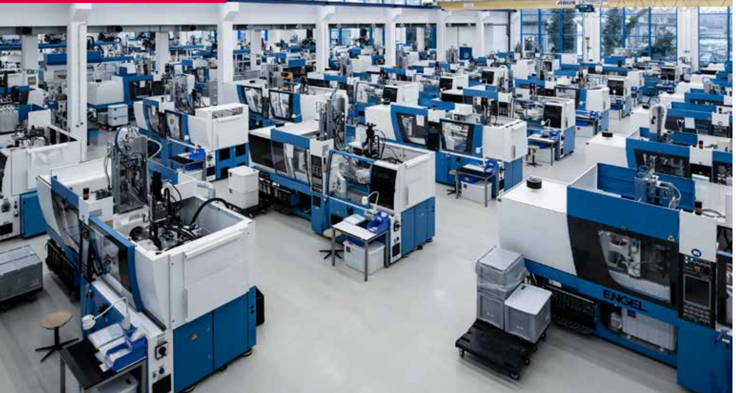
In der Produktion von Starlim werden verschiedenste Silikonteile gefertigt, die sich im Auto wiederfinden. Bild: Starlim Spritzguss GmbH
