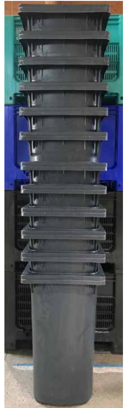
Die Recyclingmülltonnen halten auch dem Stapeltest problemlos stand. Damit ist ein sicherer Transport von bis zu 13 gestapelten Tonnen möglich.
