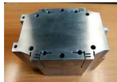
WAAM-gefertigter Einsatz aus AW-5183 nach der Feinbearbeitung Bild: Fachhochschule Wels
