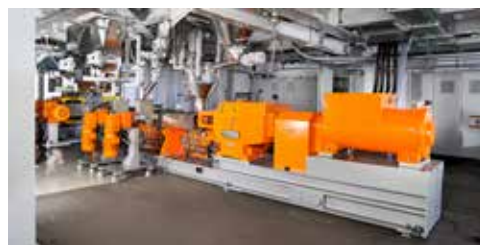
Beispiel eines ZSE 60 MAXX Doppelschneckenextruders Bild: Leistritz
