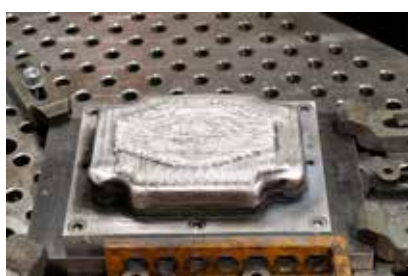
Additiver Aufbau des Spritzgießeinsatzes Bilder: TU Ilmenau
