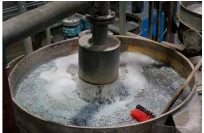
Waschen und Shreddern der PET-Abfälle mittels Heißwäsche bei 60 °C Bild: Michael Heinzreiter e.U.
