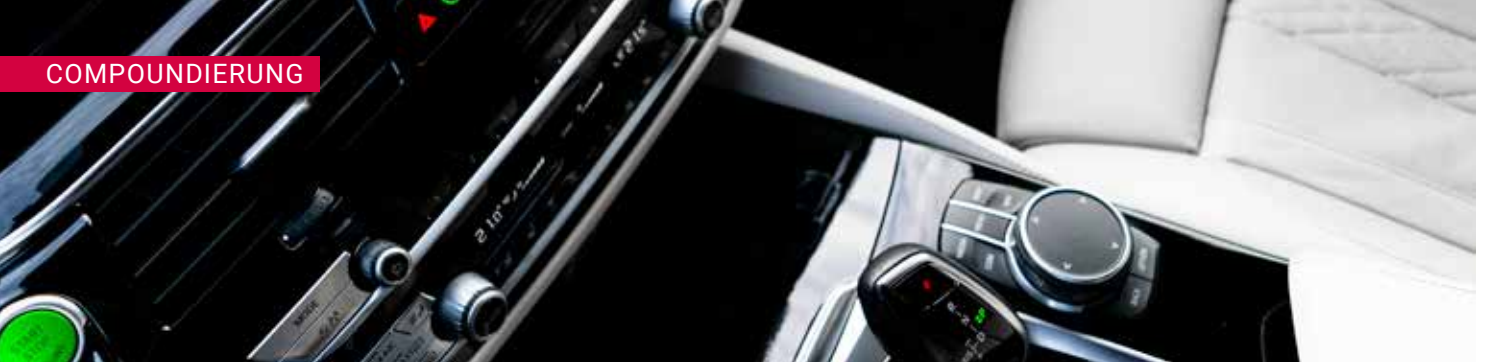
Hochglänzendes Polyamid mit hoher Kratzfestigkeit ergibt den idealen Werkstoff für Klavierlack-Optik im Auto. Bild: AdobeStock
