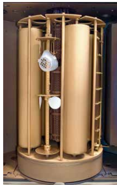
Beschichtung einer Kunststoffmaske
