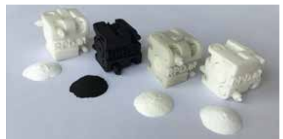
TPU; PA11-CF; PA6 GB; PP (v.l.n.r.) als kleiner Einblick in mehr als zehn Hochleistungskunststoffe für die Additive Fertigung Bild: RPD GmbH
