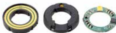
Mit Epoxidharz mediendicht verkapselte und damit sterilisierbare Kleinelektronik mit LED Bild: W&H
