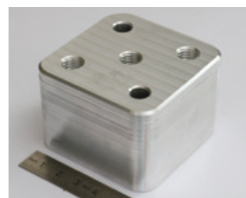
Abb. 8: Das geschweißte Bauteil nach dem groben Zerspanen.
