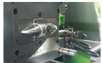
Spritzgusswerkzeug mit zwei Einsätzen (konventionell + additiv gefertigt)
