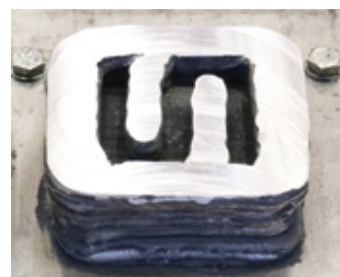
Abb. 5: Das Aufbauen der unteren Lagen mit dem Temperierkanal (nachbearbeitet).
