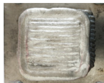
Abb. 7: Das fertig geschweißte Bauteil vor der Nachbearbeitung.
