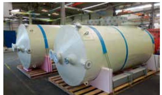
Die Behälter gewähren sicheren Umgang mit Säuren und Basen. Bild: Heson
