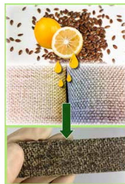
Herstellung eines Composites mit 100 % biobasiertem Kohlenstoffanteil auf Basis von Leinsamenöl, kristalliner Zitronensäure und Flachsfaserverstärkung. Bild: Montanuniversität Leoben
