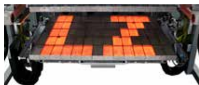
Materialtemperierung: Infrarot-Heizsysteme heizen bis zu 500 °C auf. Bild: Langzauner
