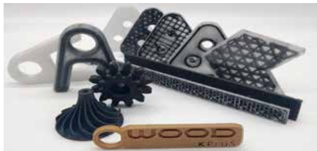
Leichtbauteile aus Biocomposite-Materialien. Bild: Wood K plus
