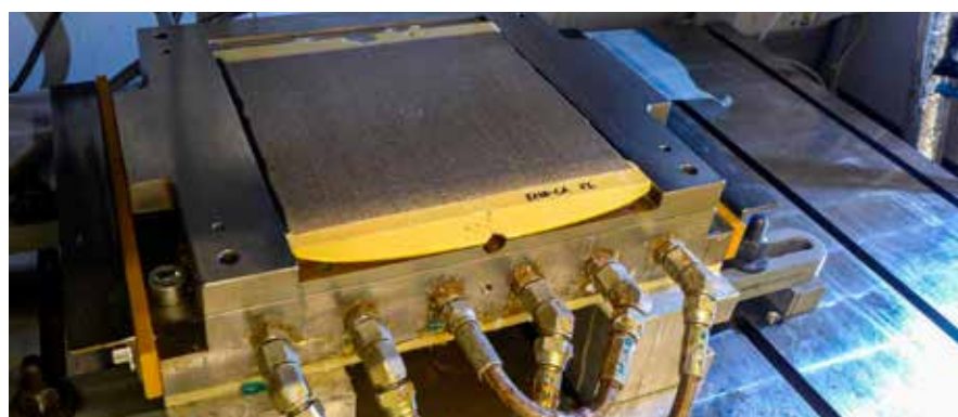
Einsatz der biobasierten Harzrezeptur im Resin Transfer Moulding-Prozess für die Herstellung eines Green Composites. Bild: Montanuniversität Leoben
