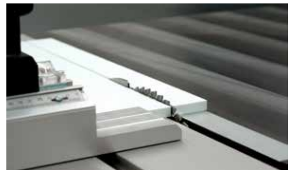
Kreissägeblatt BrillianceCut sägt Kunststoffe ohne Riefen Bild: Leitz
