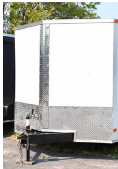
Die Strukturverklebung der Leichtbauplatte mit den Rahmenprofilen reduziert bei Anhängern und Sonderaufbauten die Zahl der Arbeitsschritte und die Dauer der Durchlaufzeiten.
