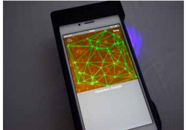
Mit TagTec Masterbatch Formulierungen erhalten Kunststoffteile eine individuelle DNA - eine Identitätssignatur wie die eines Fingerabdrucks. Bild: Gabriel-Chemie GmbH
