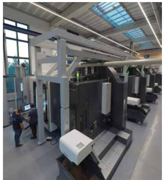
Die vier verketteten DMU 80 P duoBLOCK Bearbeitungszentren von DMG MORI mit einem Vorrat von bis zu vier Tagen Bild: Haidlmair
